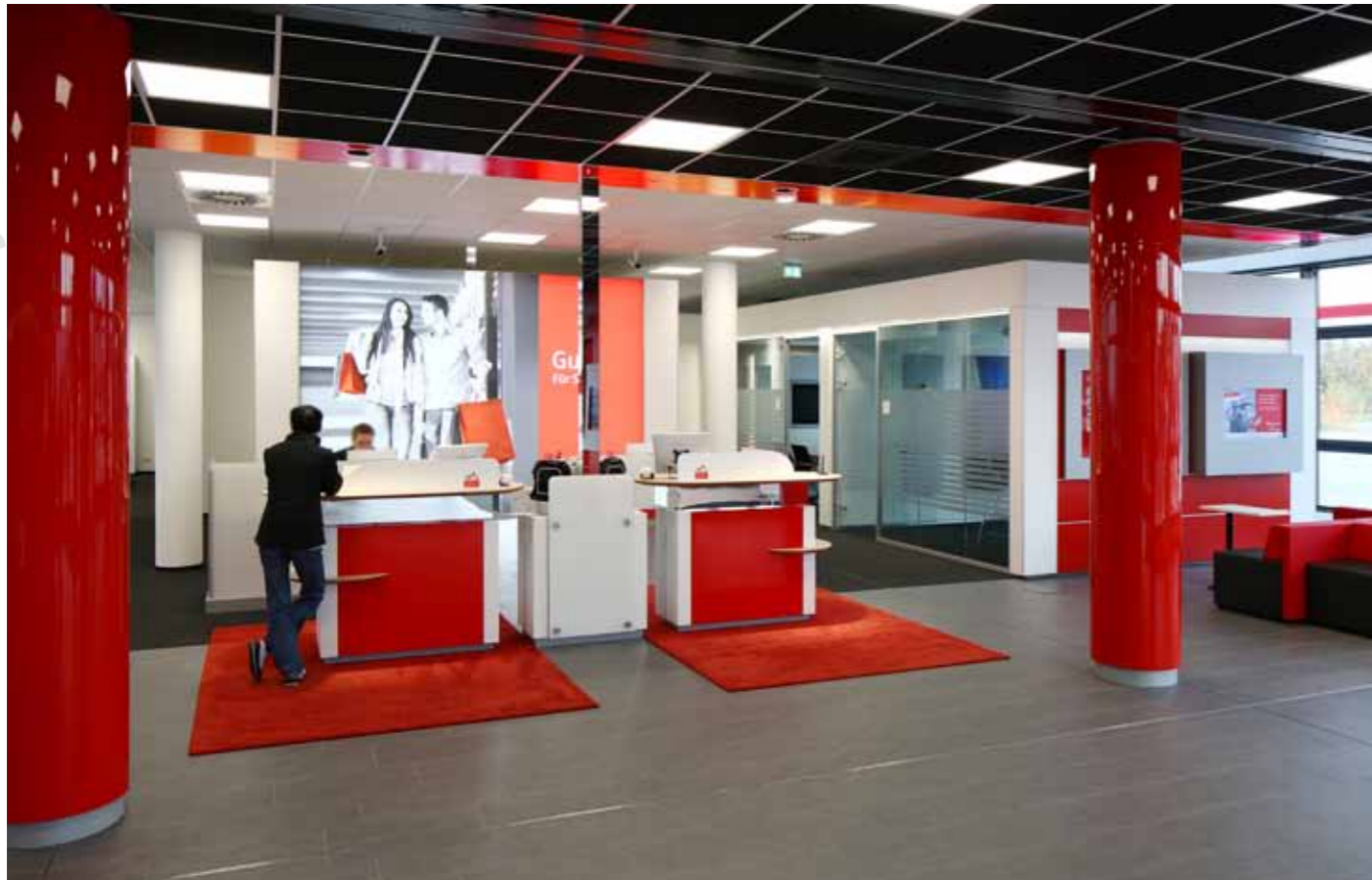
▲ Der „raumbildende Ausbau“ ist unabhängig von der Gebäudehülle, dadurch hoch flexibel und rückbaufähig. Die Elektrifizierung aller Bauteile erfolgt über die Decke
