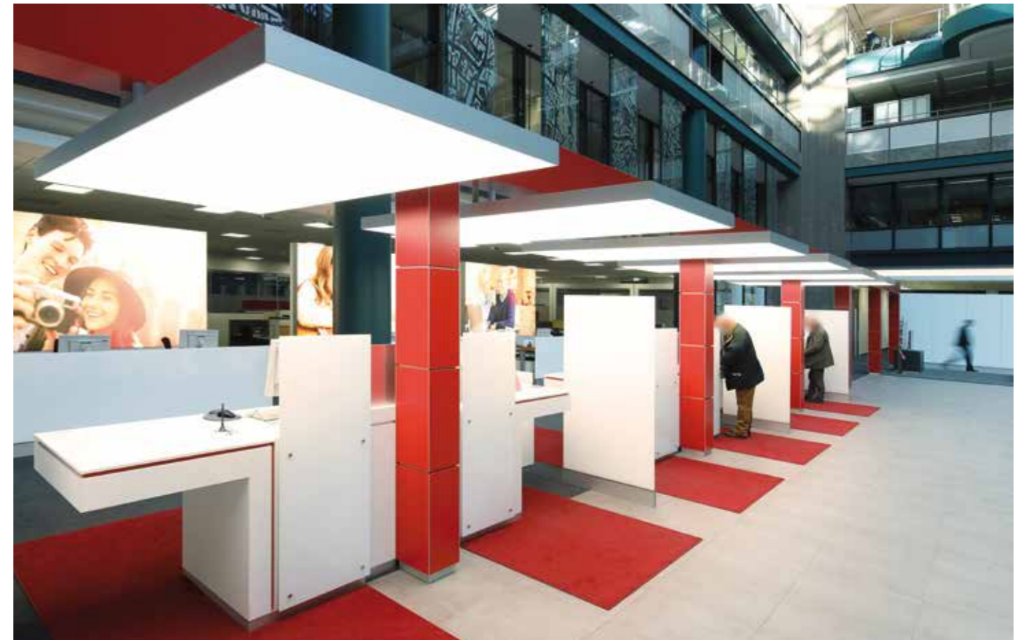
▲ Durch den Viadukt sorgen die großflächigen Deckensegel gleichzeitig für optimale Beleuchtung und Blendfreiheit bei Sonneneinstrahlung
